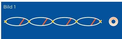
Nimmt man z. B. einen Schlauch und bestrahlt ihn, werden chemische Bindungen - Vernetzungen - zwischen den Molekülketten hergestellt. Bild 1 zeigt einen einfachen Ausschnitt zweier miteinander vernetzter Molekülketten.
