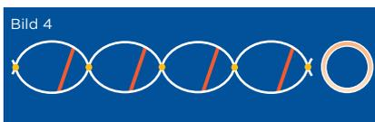
Beim Abkühlen des Schlauches in seiner expandierten Form unter +120°C bilden sich die kristallinen Zonen zurück und fixieren den Schlauch in expandiertem Zustand (Bild 4). Diese Form ist die Lieferform wärmschrumpfender Materialien.
