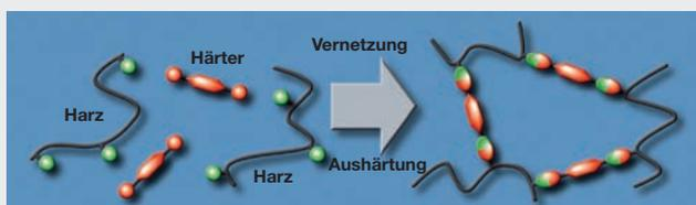
Bild 1 Schematische Darstellung der Reaktion bei Polyurethanen
