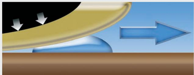
Bild 2 PowerGel - Verdrängung von Feuchtigkeit
