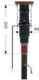
RSSS-VD: Gerader Stecker mit kapazitivem Prüfkontakt
