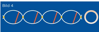
Beim Abkühlen des Schlauches in seiner expandierten Form unter +120°C bilden sich die kristallinen Zonen zurück und fixieren den Schlauch in expandiertem Zustand (Bild 4). Diese Form ist die Lieferform wärmeschrumpfender Materialien.
