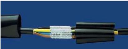
Nachdem die Kabelenden gemäß Anleitung vorbereitet wurden, schiebt man die expandierten Innenmuffen sowie die Außenmuffe über die Aderenden. Die Leiterverbindung kann jetzt hergestellt werden.
