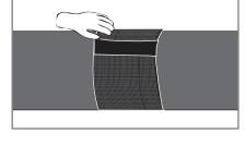
**4.** Die Manschette mit einer weich eingestellten, gelben Propangasflamme von der Mitte ausgehend unter gleichmäßiger Bewegung in Umfangsrichtung aufschrumpfen.
