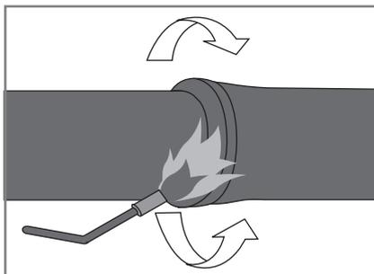
**2.** Vorhandene Leckagen mit Dichtband S 1057-2 temporär abdichten. Unter Verwendung eines Propangasbrenners das Rohr im Installationsbereich auf ca. +60 °C vorwärmen.
