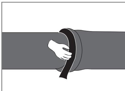
**3.** Das in der GRSM-F Garnitur enthaltene Profildichtungsband (S 1052) füllt den Übergang von der Muffe zum Rohr komplett auf und soll ca. 5 mm über den Muffendurchmesser überstehen. Das Profildichtungsband wie dargestellt an der Muffenstirn anlegen.
