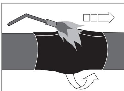
**5.** Die GRSM-F-Manschette mittig im Muffenbereich beginnend mittels weich eingestellter gelber Flamme unter gleichmäßiger ringförmiger Bewegung um das Rohr aufschumpfen. Danach von der Muffe aus die Manschette zur anderen Seite hin in der gleichen Weise aufschumpfen.
