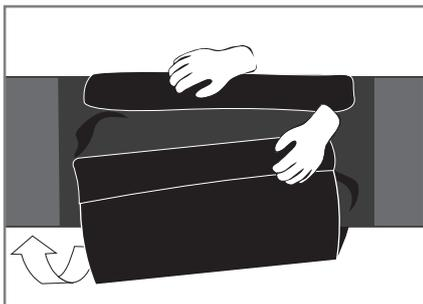
**3.** Die Manschette mittig auf der Schweißstelle rechtwinklig zur Rohrachse platzieren. Die HTLP-Manschette soll auf beiden Seiten mindestens 50 mm auf der Werksumhüllung aufliegen. Die Manschette mit Verschlusslasche so herumlegen, dass die gegenüberliegende Kante die andere Kante um 50 mm überlappt.
